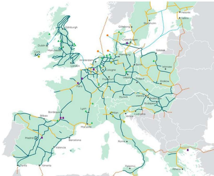
Fig.4 : Configuration du réseau Européen de transport de l'hydrogène à l'horizon 2040.
