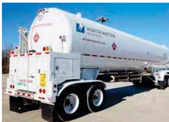
Figure n° 17 - Exemple de camion de transport d'hydrogène liquide
