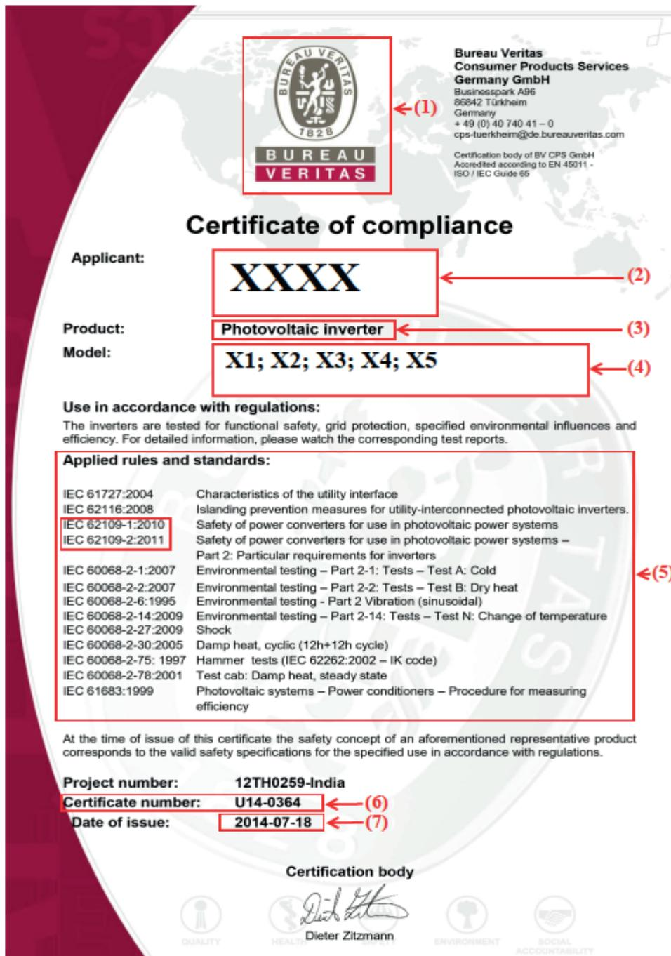
Figure 25. Exemple de certificat de conformité pour onduleur solaire.
