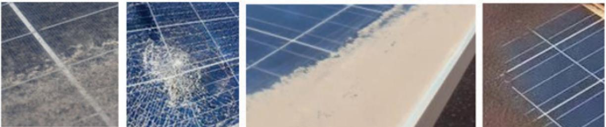
Figure 36. Exemples d'encrassement de modules PV.
