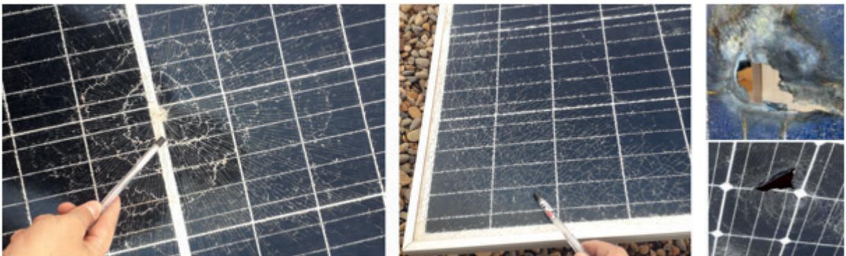
Figure 33. Exemples de bris de verre de modules PV.
