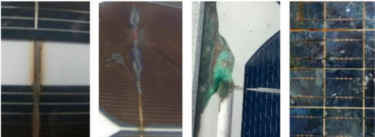
Figure 27. Exemples de corrosion des interconnexions.
