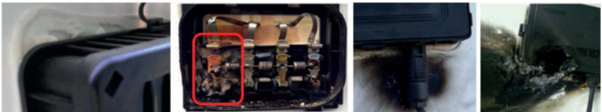
Figure 34. Exemples de défauts relevés au niveau de la boîte de jonction PV.
