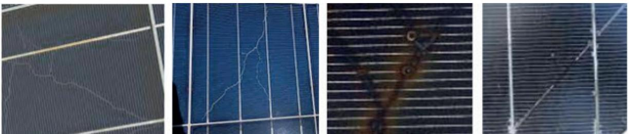
Figure 30. Exemples de fissure sur des cellules PV.
